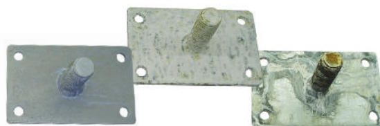
ZiNiP after 1500 h Feuerverzinkt 55 µm after 408 h Galvanisch verzinkt after 240 h
